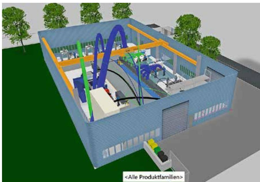
Relevante Materialflüsse für die Fabrikplanung werden im 2D- oder 3D-Layout hinterlegt und in Echtzeit planerisch ausgewertet
